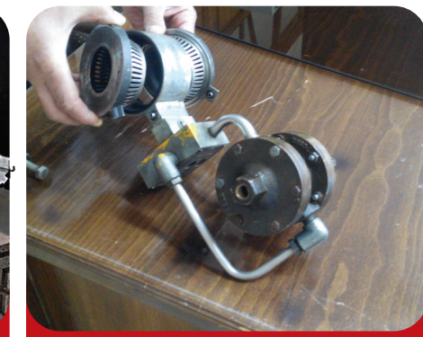
۳- قراردادن کلوزر مجهز به سایلنسر درون رگولاتور
